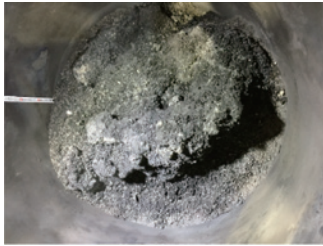
図 15 ガス化炉内に形成されたクリンカ 11)
